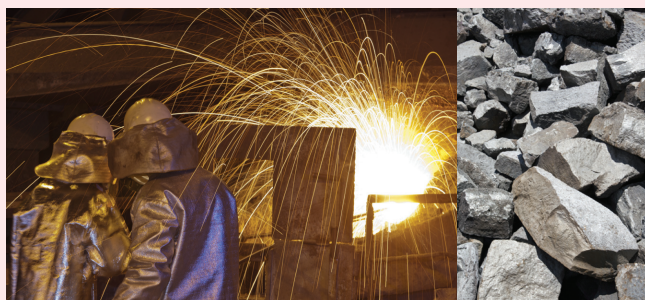
À gauche : l'ouverture du four ; à droite : le produit fini, des blocs de ferro-alliage. © GUILBERT Michel.
