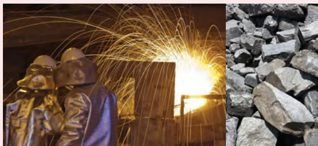
À gauche : l'ouverture du four ; à droite : le produit fini, des blocs de ferro-alliage. © GUILBERT Michel.
