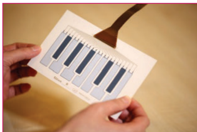
Figure 7 - Clavier piézoélectrique imprimé sur papier utilisant un film fin de copolymère poly(VDF-co-TrFE) comme couche active (© CEA-Liten/Arkema/Arjowiggins) [36].
