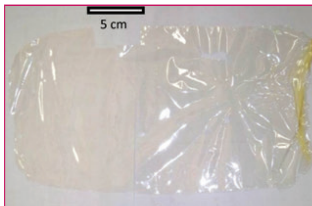
Figure 6 - Photographie de membrane constituée d'un mélange poly(chlorotrifluoroéthylène- alt -éther vinylique porteur de fonction triazole) (40 wt%)/s-PEEK (60 wt%) obtenue par casting sur substrat de verre (épaisseur : ca. 20 µm).
