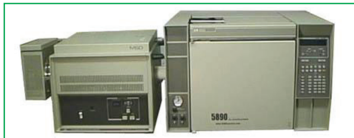
Figure 2 - Image d'archives d'un MSD Hewlett-Packard (modèle 5890 GC/modèle 5970B MS) identique à l'équipement en service au DCC/KIST de Séoul en 1988. Reproduit avec l'aimable autorisation d'Agilent.
