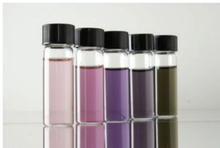
Suspensions dans l'eau de nanobâtonnets d'or dont la couleur dépend du rapport d'aspect (longueur sur diamètre). © S. Lagache.
