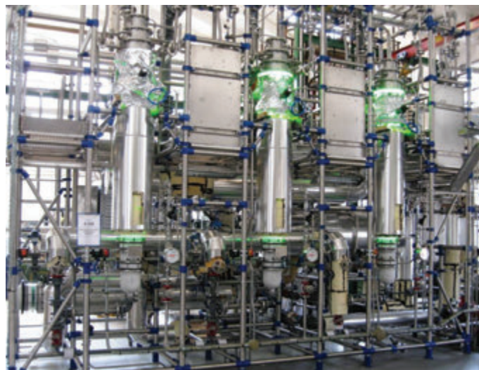
Figure 20 - Réacteur photochimique de taille industrielle sur le site de Garessio (Italie). Adapté avec permission de [32], © 2017 American Chemical Society.
