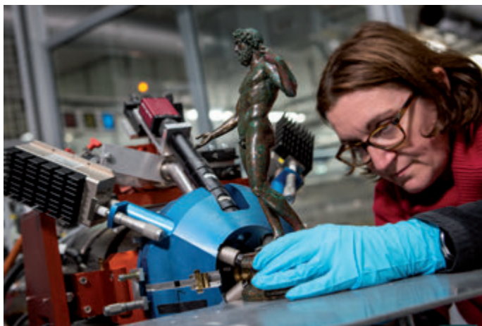
Statuette de bronze du Trésor de Bayray placée à la sortie du faisceau et entourée du multi-détecteur. © Christophe Hargoues/C2RMF/CNRS Photothèque.
