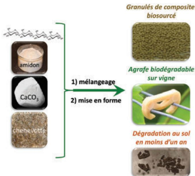
Figure 10 - Agrafes biodégradables à durée de vie contrôlée pour le palissage des vignes (mélange composite thermoplastique à base de polymères naturels (amidon, Vegemat®), de charges minérales et de fibres biosourcées).
