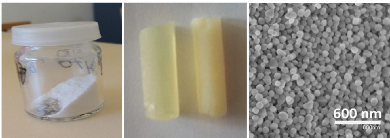
Figure 2 - Différentes morphologies d'ionosilices. De gauche à droite : poudre, monolithes, obtenus par extraction en milieu  $\text{scCO}_2$ , nanoparticules.
