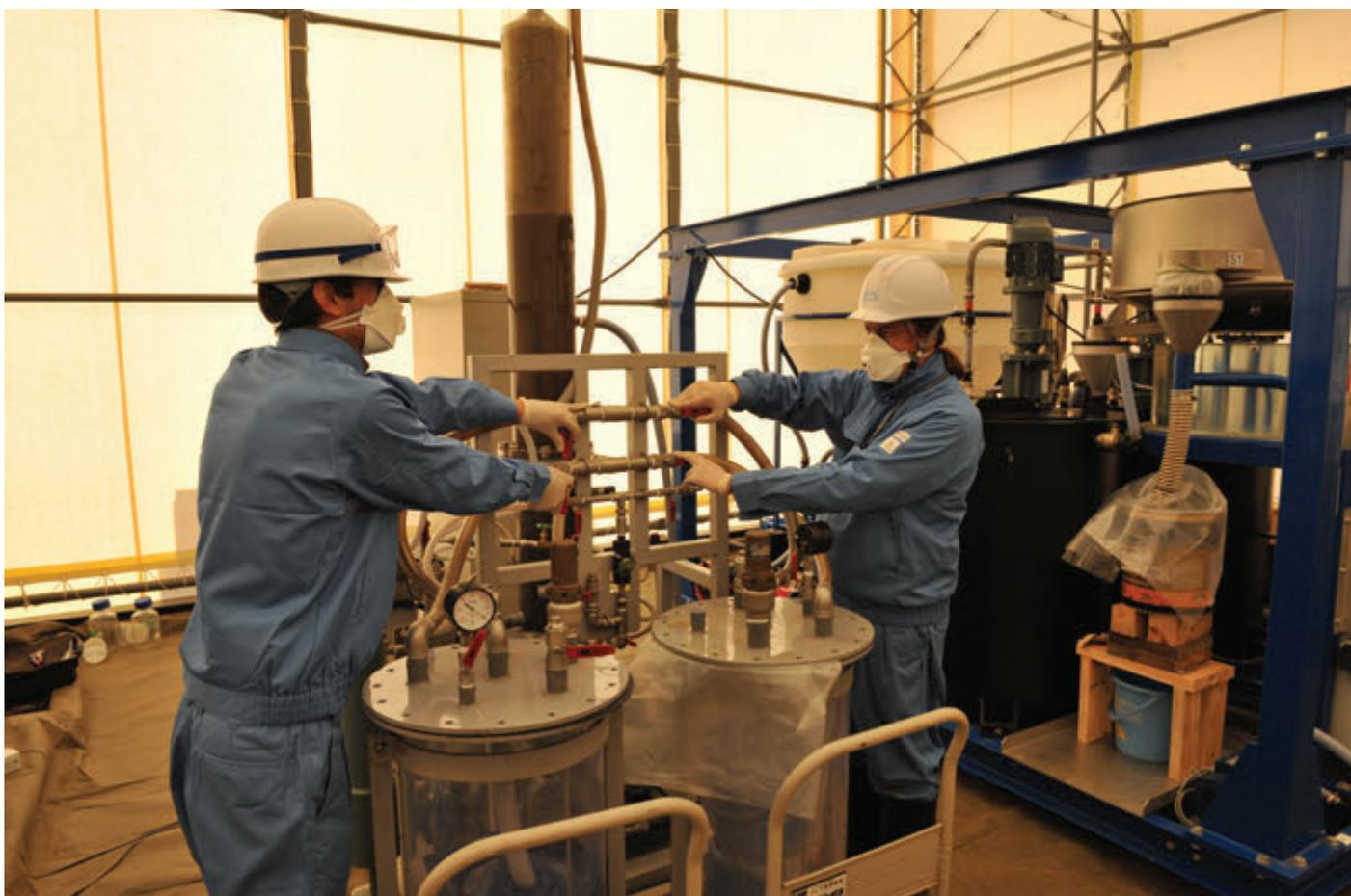
Figure 1 - Collecte de la mousse sur le pilote de flottation utilisé au Japon. © J.-L. Sida/CEA.
