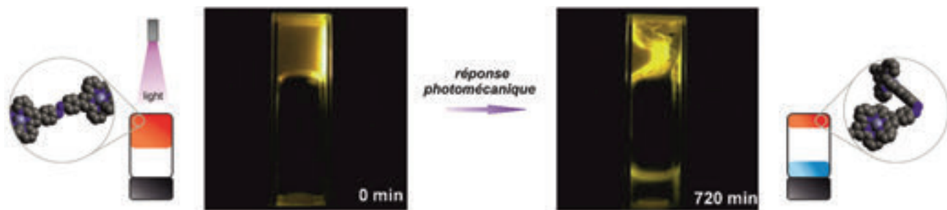
Figure 5 - Contraction du gel et libération du solvant suite à une irradiation UV continue à 365 nm, illustrant une réponse photomécanique macroscopique.
