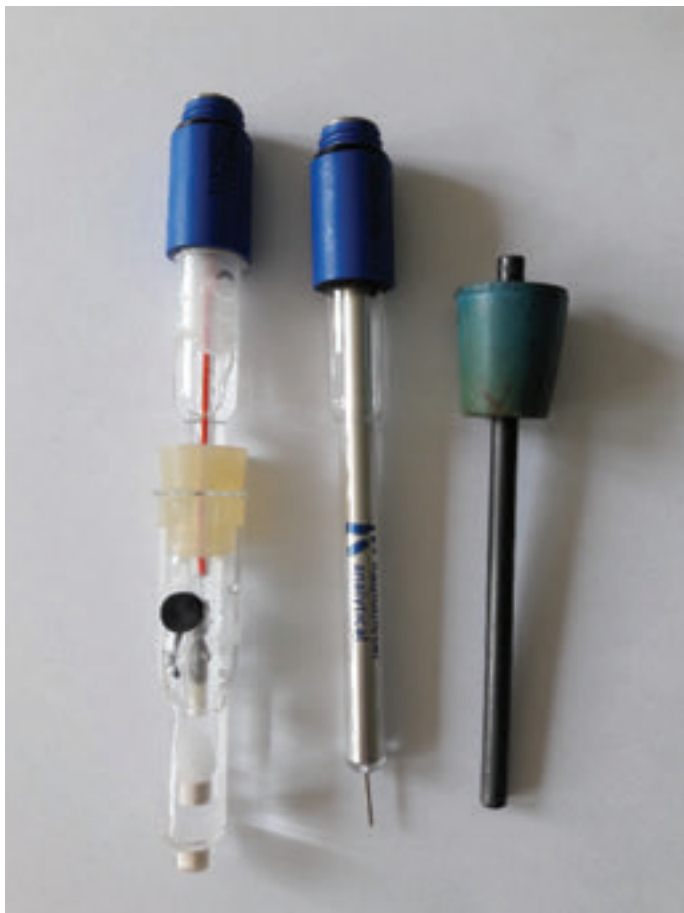
Figure 1 - Électrodes utilisées (de gauche à droite) : électrode au calomel saturée avec allonge de protection, électrode de platine, électrode de graphite.
