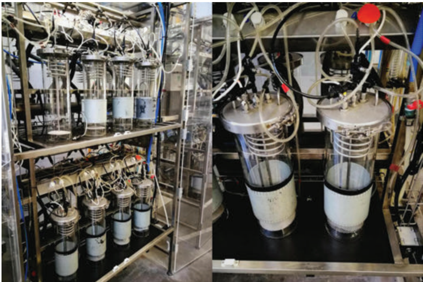
Figure 2 - Équipement de biodégradation par respirométrie (photo Valagro Recherche, DR).
