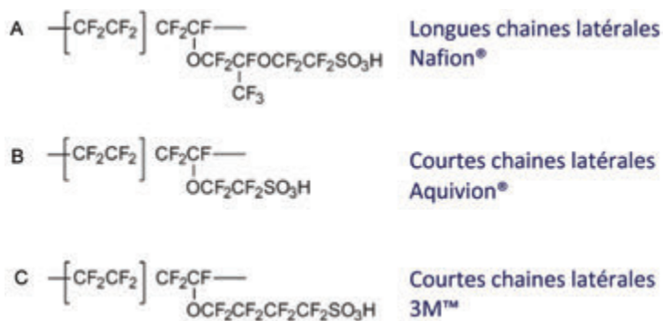
Figure 2 - Structures chimiques d'ionomères de type PFSA à chaîne latérale longue (A) et courte (B, C).
