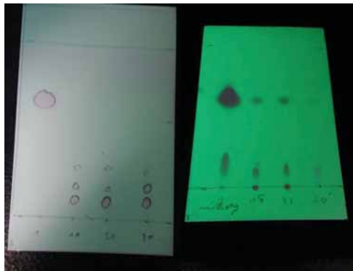
Figure 3 - Suivis par CCM de la synthèse des composés 7 (à gauche) et 8 (à droite) par réaction de Wittig à reflux de l'eau. À gauche : l'éluant est un mélange acétate d'éthyle/cyclohexane 40/60, le 4-nitrobenzaldéhyde commercial sert de référence (dépôt à gauche de la plaque) et les dépôts suivants correspondent au milieu réactionnel après 10, 20 puis 30 min de reflux. À droite : l'éluant est un mélange acétate d'éthyle/cyclohexane 30/70, le 4-méthoxybenzaldéhyde commercial sert de référence (à gauche de la plaque) et les dépôts suivants correspondent au milieu réactionnel après 15, 33 puis 60 min de reflux.
