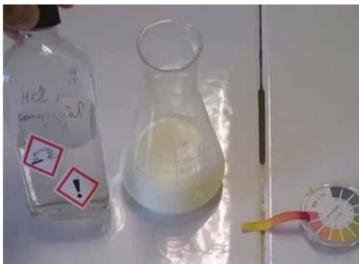
Figure 6 - Précipitation de l'acide carboxylique 8Z par acidification du filtrat.
