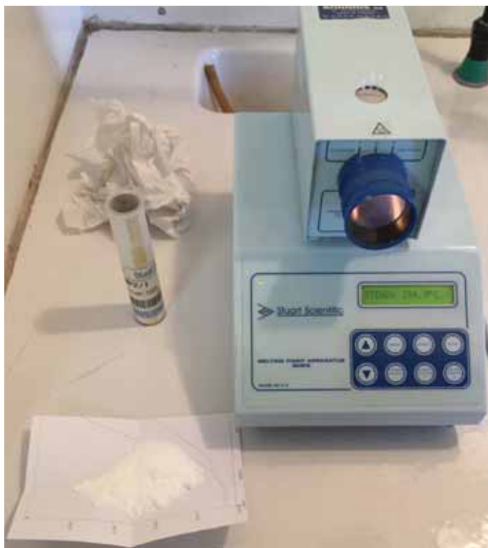
Figure 2 - Bromure de phosphonium 2 brut obtenu (poudre incolore) et mesure de son point de fusion.
