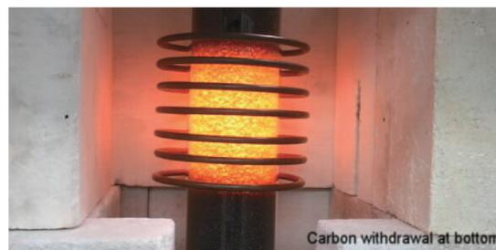
Figure 3 - Obtention d'hydrogène par pyrolyse du méthane.
