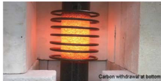
Figure 3 - Obtention d'hydrogène par pyrolyse du méthane.
