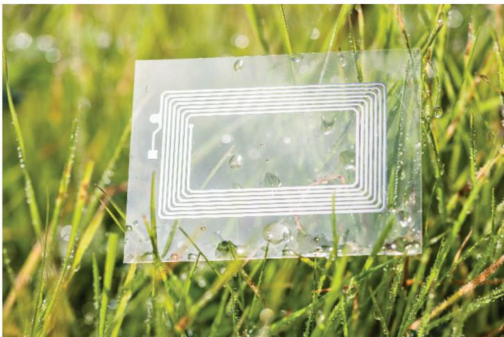
Figure 5 - Antenne RFID souple imprimée sur PET avec une encre conductrice d'argent de GenesInk.
