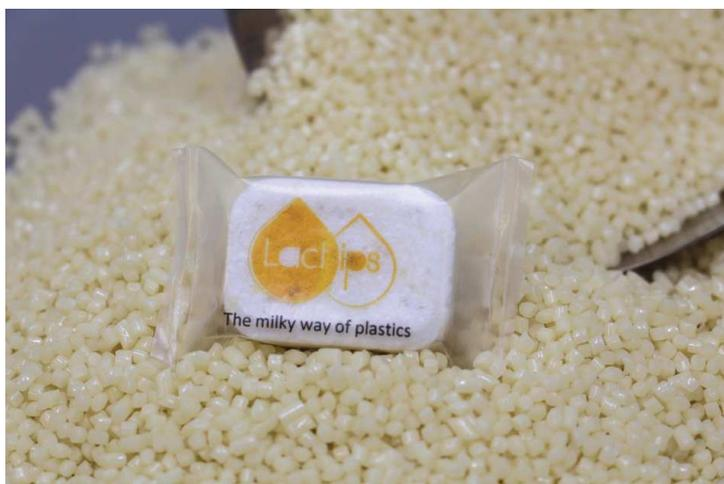
Figure 8 - Exemple d'un emballage soluble Lactips pour une poudre de détergence.
