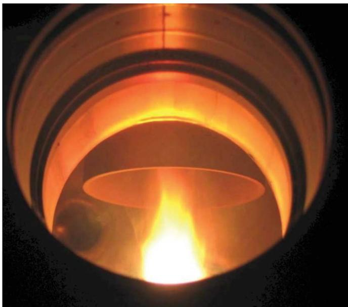
Figure 2 - Flamme de la pyrolyse laser.
