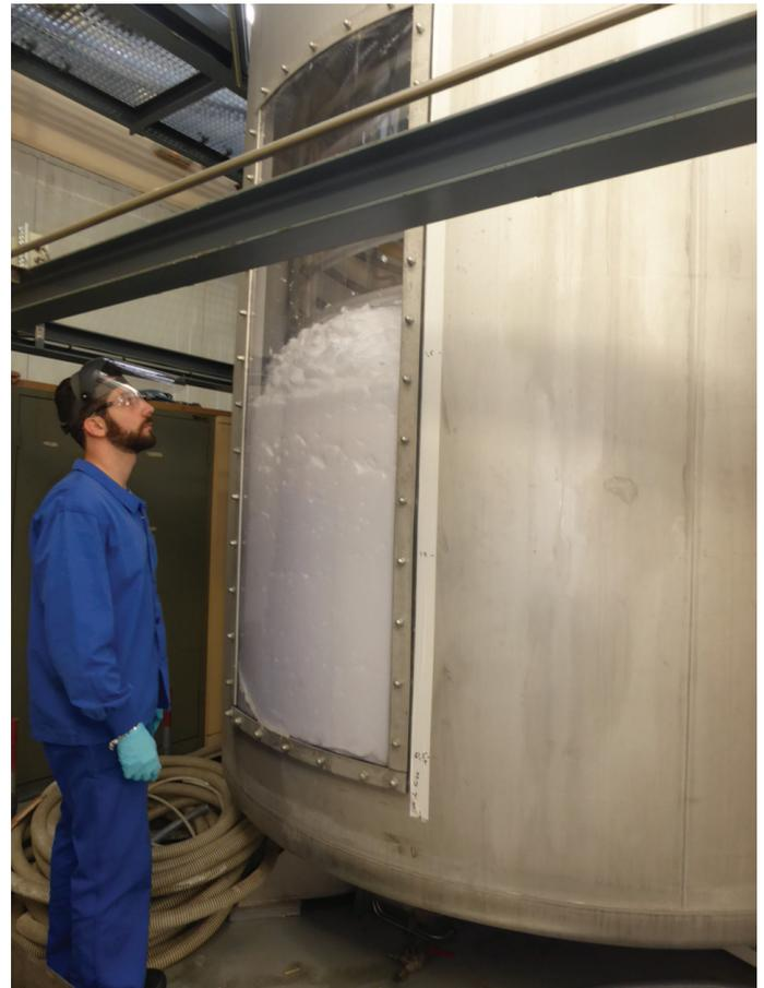
Figure 5 - Mise en œuvre de la mousse en remplissage d'une cuve de 20 m<sup>3</sup> (4 m de hauteur sur 2,6 m de diamètre). © CEA/Laboratoire des procédés supercritiques et décontamination.
