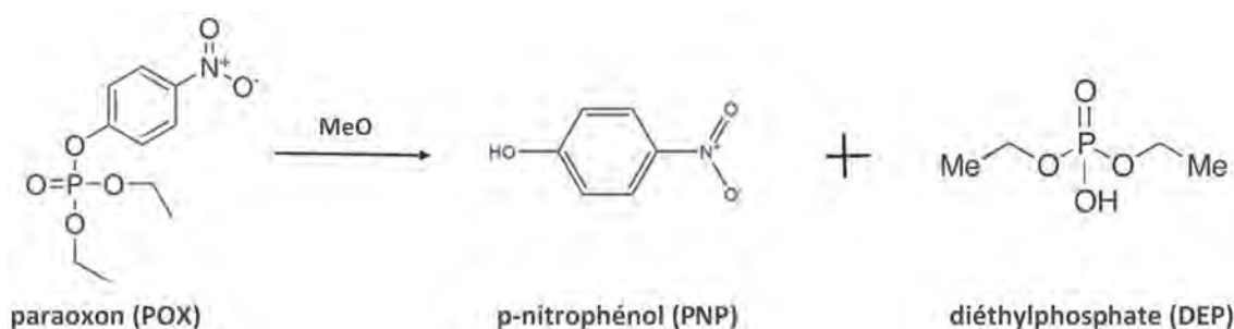
Figure 3 - Dégradation du paraoxon en surface des nanoparticules d'oxyde métallique.
