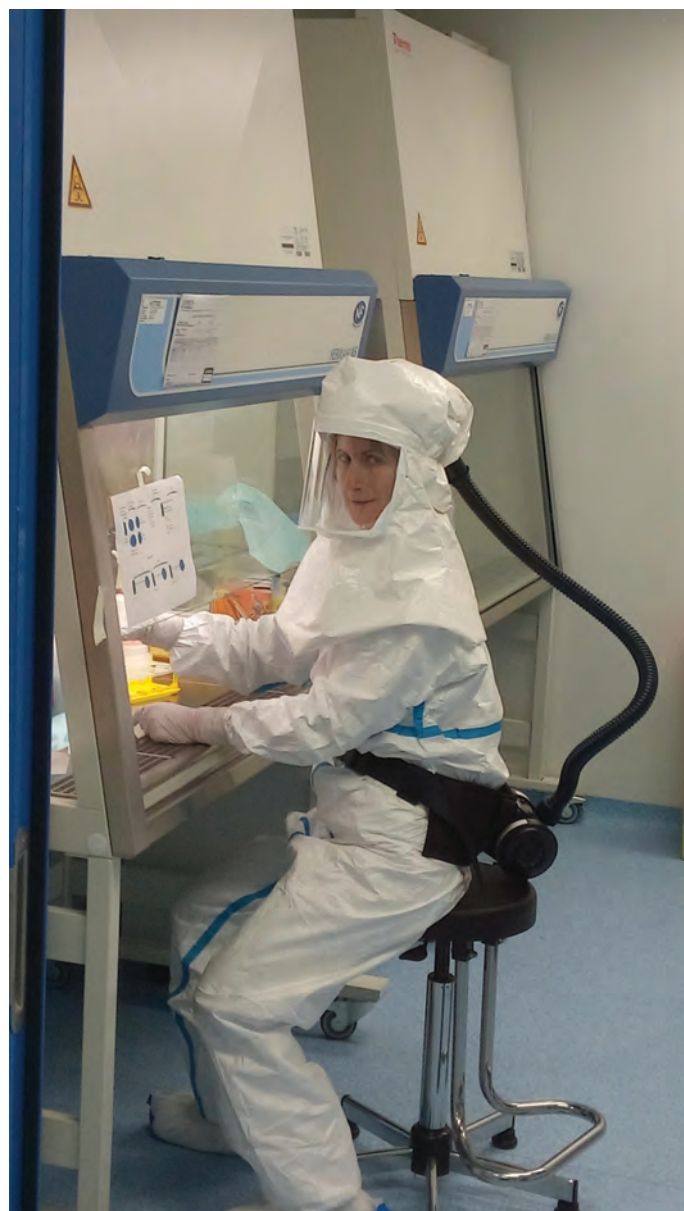
Figure 2 - Tests d'inactivation des mousses biocides sur des spores de Bacillus anthracis réalisés en laboratoire de haute sécurité biologique (confinement niveau 3).
