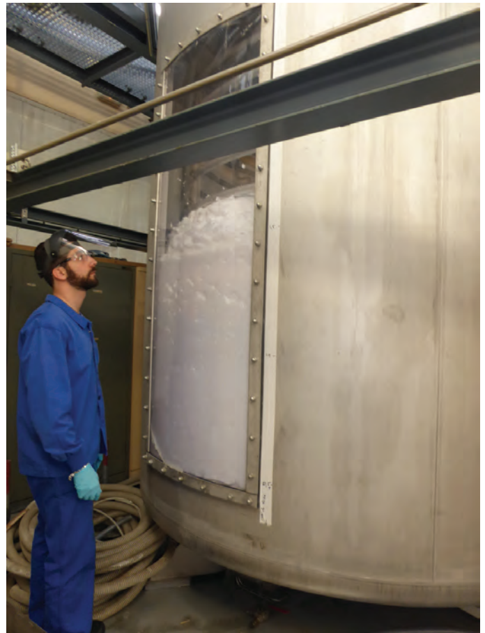
Figure 5 - Mise en œuvre de la mousse en remplissage d'une cuve de 20 m 3 (4 m de hauteur sur 2,6 m de diamètre). © CEA/Laboratoire des procédés supercritiques et décontamination.
