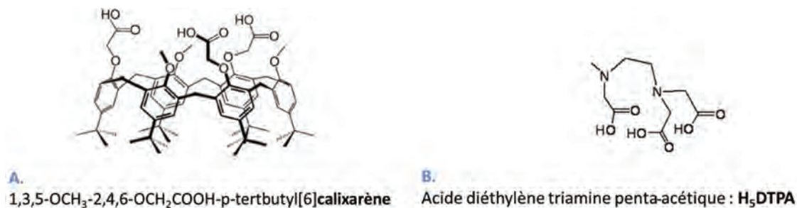
Figure 2 - Structures du calixarène et du DTPA, deux agents chélatants utilisés pour la décontamination des actinides.
