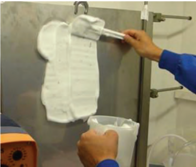
Figure 4 - Mise en œuvre de la mousse par talochage avec une spatule sur une plaque d'inox verticale (1 m x 1 m). © CEA/Laboratoire des procédés supercritiques et décontamination.
