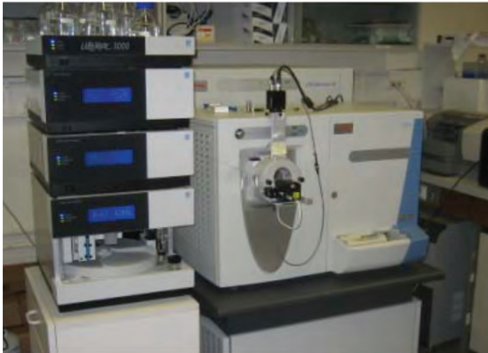
Figure 1 - Nouveaux outils pour le séquençage des acides nucléiques et l'identification des protéines. En haut : séquenceur nanopore type MinION de la société Oxford Nanopore Technologies ; en bas : spectromètre de masse à haute résolution de la société Thermo incorporant un analyseur orbitrap couplé à une chaîne de chromatographie liquide à très faible débit.
