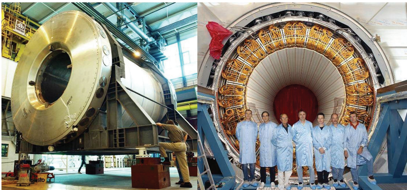
Figure 7 - Calorimètre ATLAS du CERN en cours de construction (à gauche) et avec sa couronne de « tuiles scintillatrices » (à droite). ATLAS Experiment © 2016 CERN.
