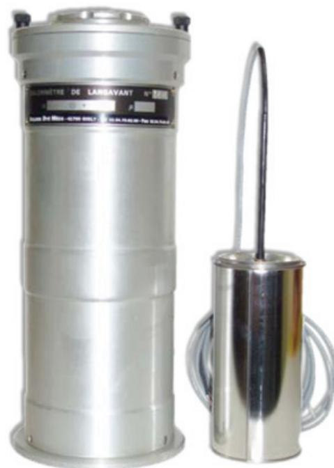
Figure 10 - Dispositif calorimétrique développé par J. Cléret de Langavant dès 1938 [10]. Un cylindre de mortier normalisé est coulé dans le conteneur représenté à droite, avec en son centre un capteur de température, puis placé dans le vase Dewar de 16 cm de diamètre et de 40 cm de haut.
