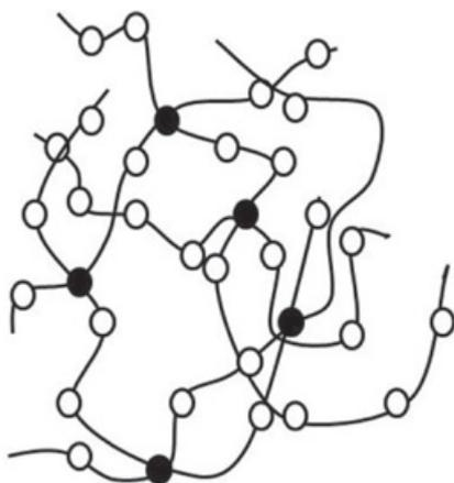
Figure 2 - Polymère thermodurcissable ; les nœuds de réticulation sont symbolisés par des points noirs.
