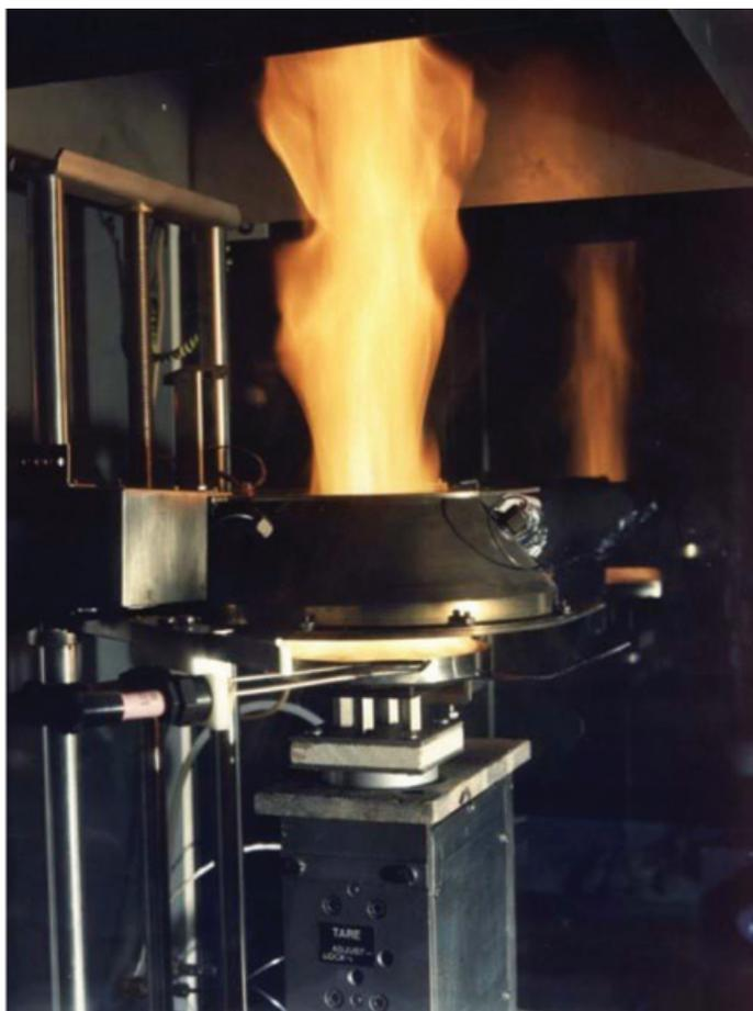
Figure 10 - Photographie d'un « calorimètre à cône » en fonctionnement, d'un principe équivalent à celui qui est détaillé dans la figure 11 (on aperçoit la hotte au sommet de la flamme).
