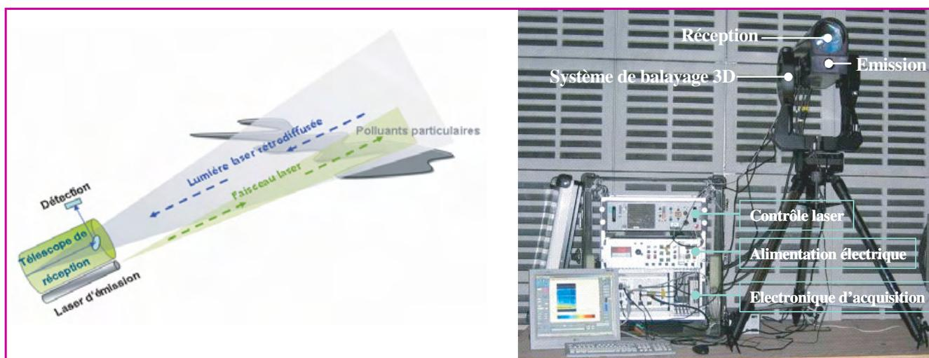
Figure 1 - Système LIDAR LAUV (LIDAR Aérosol UltraViolet) développé par le CEA et le CNRS pour des applications en air extérieur et intérieur.
