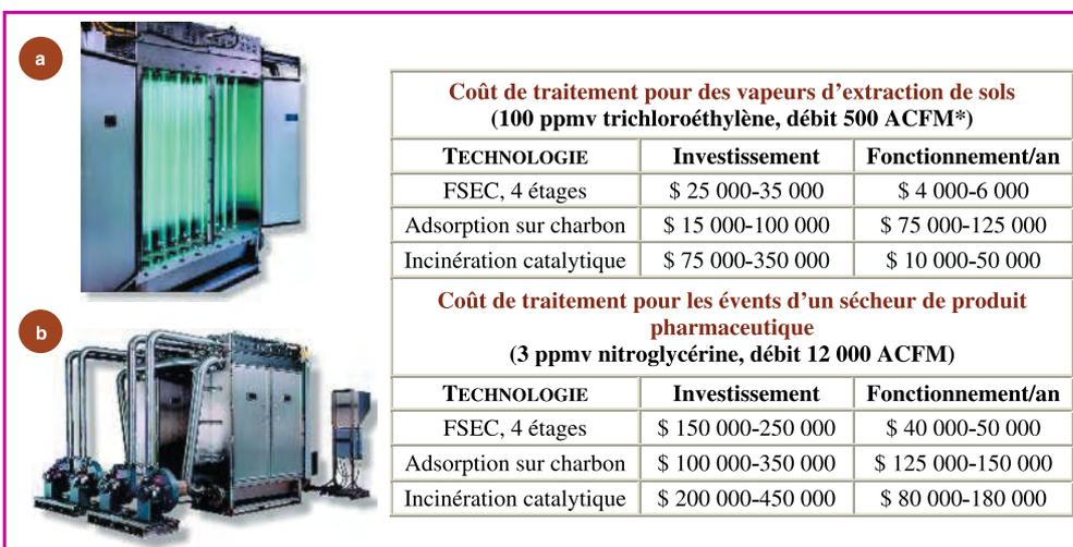
Figure 18 - Coûts comparés de la photocatalyse par rapport à d'autres procédés, pour un dispositif mis au point par FSEC [78] : a) dispositif de traitement ouvert avec vue sur les lampes ; b) dispositif de traitement fermé avec systèmes d'entrée des flux. Site web FSEC.
