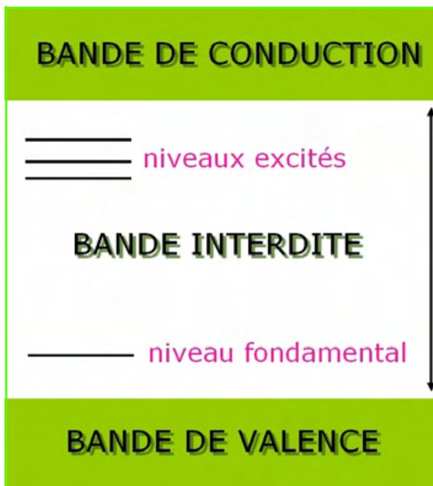
Figure 1 - Schéma de bandes d'énergie simplifié avec les niveaux d'un ion impureté qui se situent dans la bande interdite.
