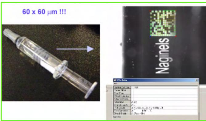
Figure 1 - Lecture d'un code barre bidimensionnel (datamix) de  $150 \mu\text{m} \times 150 \mu\text{m}$  gravé à l'intérieur d'une seringue en verre (Lasea).
