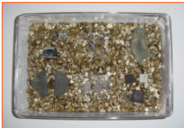
Figure 2 - Aspect de la chambre de réactivation avec les morceaux de vitraux sur lit de vermiculite.
