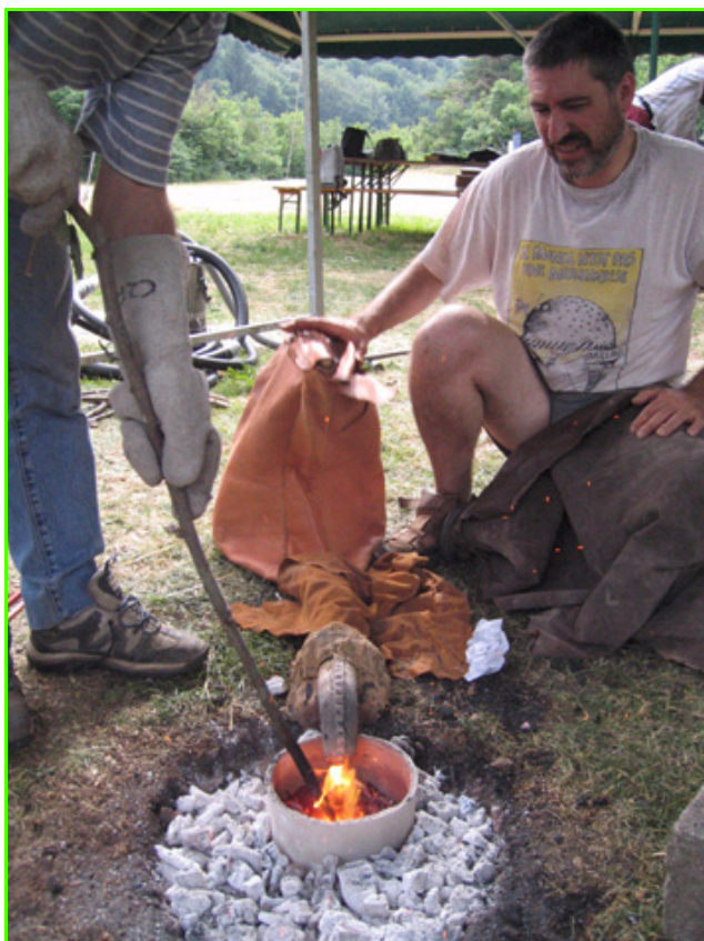
Figure 3 - Reconstruction expérimentale de réduction de cuivre dans un vase-four montrant le brassage du lit de fusion au moyen d'un bâton. © C2RMF/D. Bourgarit.
