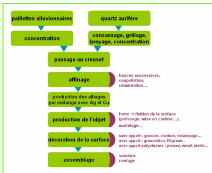
Figure 1 - Schéma de la chaîne opératoire du minerai à l'objet fini.
