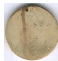
coupon traité après trois semaines d'enceinte climatique
