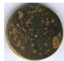
coupon non traité après trois semaines d'enceinte climatique
