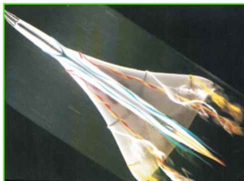
Figure 5 - Visualisation par liquides colorés, au tunnel hydrodynamique, de l'écoulement sur Concorde à basse vitesse (ONERA).
