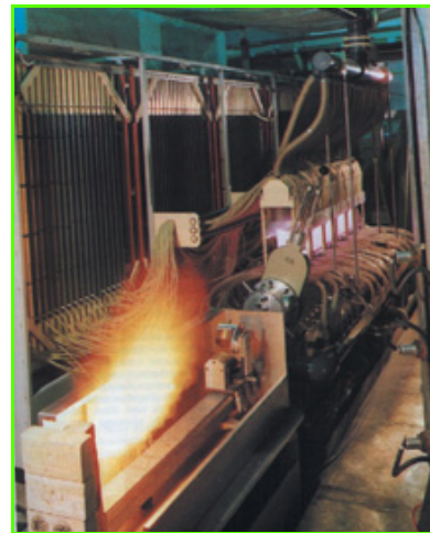
Figure 4 - Laser à gaz carbonique LEDA IV, à haute énergie (CGE).
