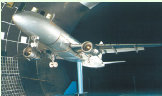
Maquette d'Airbus A 320 dans la soufflerie S1 MA (ONERA).
