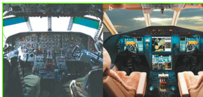
Figure 6 - Cockpits a) Caravelle (Sud-Aviation) en 1955 ; b) Falcon 900 B Primus (Dassault) en 2003.
