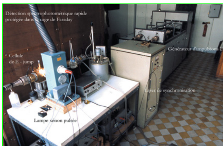
Figure 1 - Installation de relaxation chimique par saut de champ électrique (E-jump).
