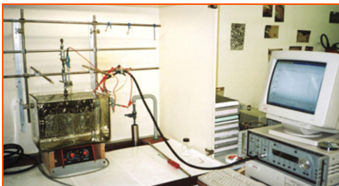
Figure 3 - Montage pour le traitement électrolytique d'une plaque d'argent doré ternie de la châsse des Enfants de Saint Sigismond de l'abbaye de Saint-Maurice [22].
