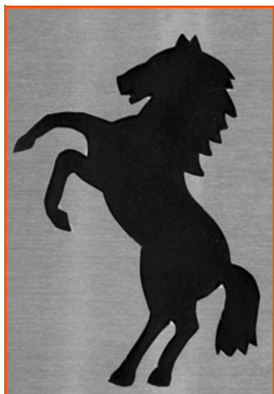
Figure 6 - « René'horse », coloration organique noire avec utilisation d'un masque sur alliage 2024T3 (122 x 82 x 1 mm) anodisé (Laurent Arurault, 2006).
