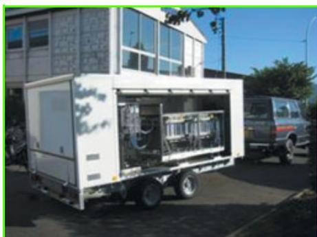
Figure 3 - Unité mobile de stabilisation tartrique ou d'ajustement de pH du vin (réf. Eurodia).
