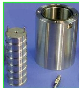
Figure 8 - Microcontacteur gaz-liquide à film tombant.
