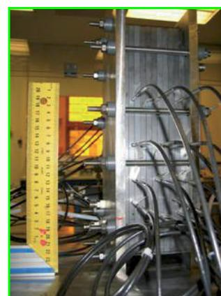
Figure 7 - Réacteur-échangeur à plaques en SiC (prototype).
