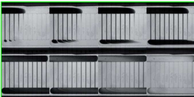
Figure 1 - Visualisation de l'écoulement dans un réseau de canaux parallèles en vue de la détection des effets de maldistribution.
