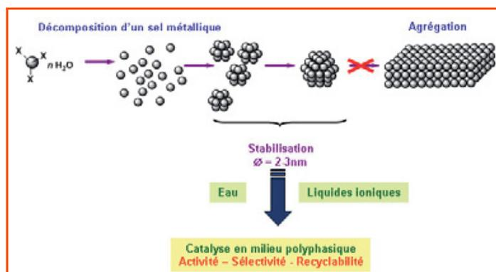
Figure 9 - Synthèse de nanoparticules à partir de sels métalliques en phase aqueuse ou liquides ioniques.
