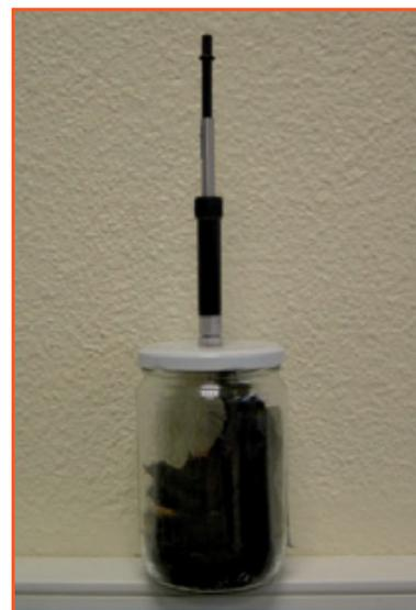
Figure 4 - Dispositif de concentration des composés volatils.
