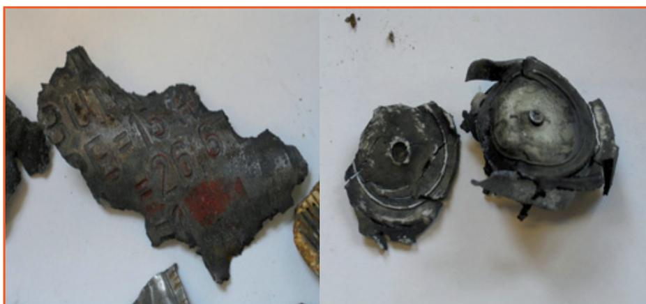
Figure 3 - Débris de bouteille de gaz avec des inscriptions caractéristiques (à gauche) et d'un minuteur (à droite).
