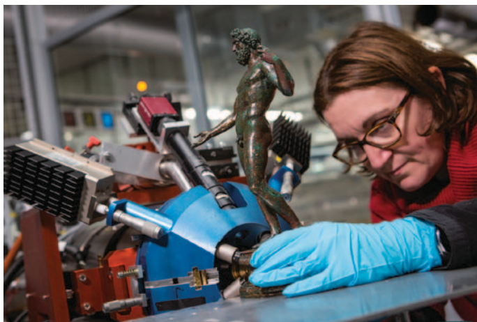
Statuette de bronze du Trésor de Bavay placée à la sortie du faisceau et entourée du multi-détecteur. © Christophe Hargoues/C2RMF/CNRS Photothèque.
