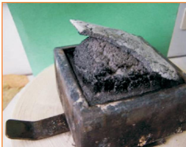
Figure 5 - Illustration du phénomène d'intumescence.
