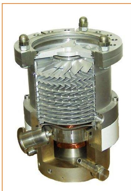
Figure 2 - Coupe d'une pompe turbomoléculaire
