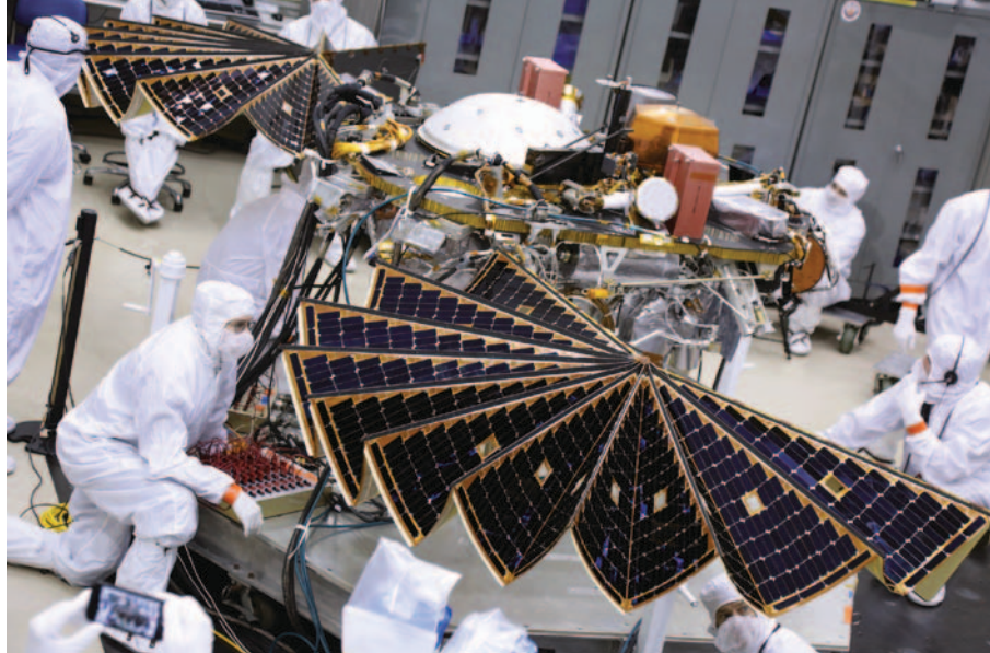
InSight : test sur les panneaux solaires de l'atterrisseur (Courtesy of Lockheed Martin, DR).
