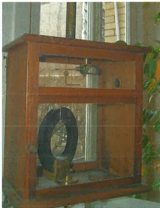
Balance destinée à mesurer les coefficients d'aimantation spécifique des éléments rares. © Musée Curie. D.R. Le coefficient d'aimantation spécifique est le rapport de l'intensité d'aimantation spécifique I = M/M ( M = moment magnétique, M = masse).
