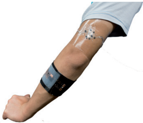
La biopile portable collée sur un bras et alimentant une diode fixée sur le brassard noir entourant l'avant-bras. © Xiaohong Chen, Département de chimie moléculaire (CNRS/Université Grenoble Alpes).
