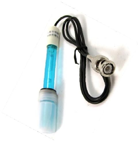
$\Delta E(\text{pH electrode})$  entre -500 mV et +500 mV dépendant du pH de la solution dans laquelle l'électrode est immergée
