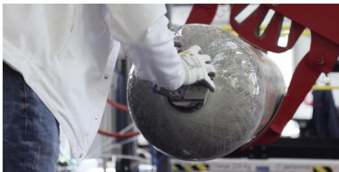
**Fig. 1.** Réservoir de stockage hydrogène 700bar
