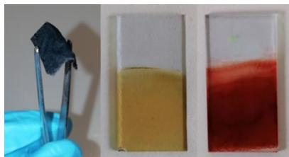
**Fig. 1.** Electrode de PPy flexible et dépôts de carbazole et de terpyridine-ruthénium sur des électrodes de FTO.
