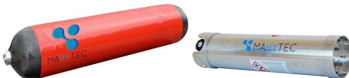
**Fig. 1.** Solution de stockage de l'hydrogène proposé par MAHYTEC. Réservoir contenant de l'hydrogène gazeux sous haute pression (500 bar) (gauche) et contenant de l'hydrogène stockée dans des hydrures solides (droite).
