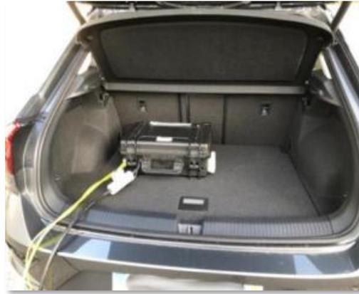
**Valise connectée Real-e**, un **analyseur de gaz d'échappement** (CO, CO<sub>2</sub>, NO<sub>x</sub>, PN, NH<sub>3</sub>...), pour une **évaluation** simple et rapide des **émissions véhicules en usage réel**
