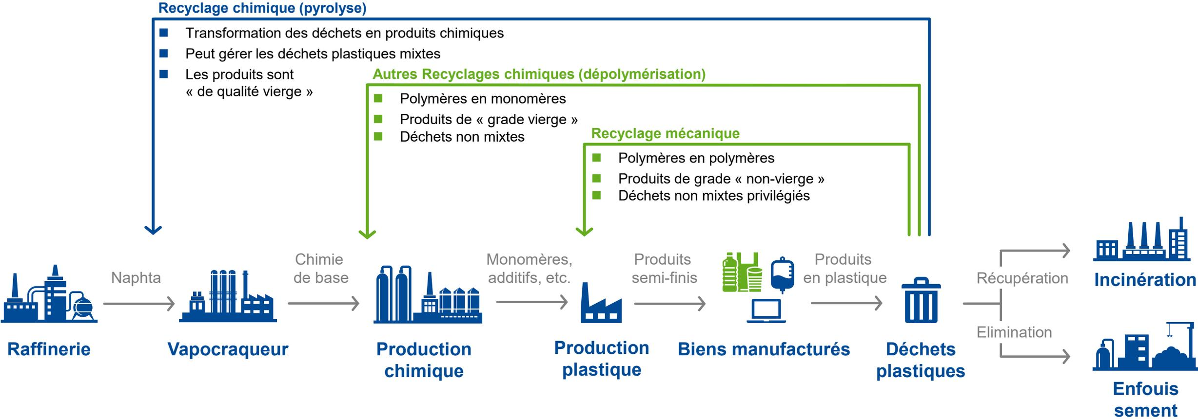
Le recyclage chimique est complémentaire au recyclage mécanique.
