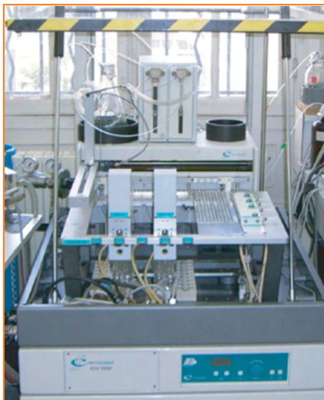
Figure 1 - Automate de synthèse parallèle (ENSCP-CNRS UMR 8151).
