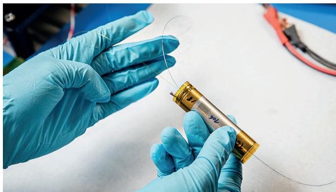
Batterie traversée par une fibre optique en verre de chalcogénure permettant de transporter de la lumière dans le domaine infrarouge. L'interaction de cette lumière avec les constituants de la batterie permet d'identifier et de suivre les molécules chimiques présentes autour de la fibre. © Frédérique PLAS/CSE/CNRS Photothèque.
