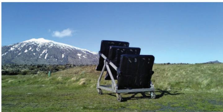
Figure 2 - Vue d'un détecteur à muons face au dôme d'un volcan islandais, le Snaefellsjökull. Les trois plans de détection ont une surface d'un mètre carré ; le détecteur pointe vers le sommet du volcan, situé à plusieurs kilomètres. © Carol Müller.
