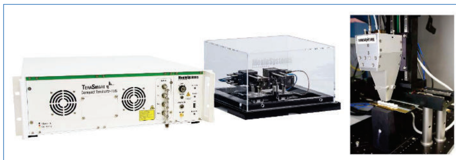
Figure 2 - À gauche, spectromètre TeraHertz dans le domaine temporel (TDS) fibré TeraSmart de Menlo Systems GmbH avec sa boîte à purge permettant de mesurer en atmosphère sèche. À droite Tête de mesure en réflexion fibrée utilisant dans un système automatique mesurant les propriétés de produit pharmaceutique. Photo : Avec l'aimable autorisation et le copyright de Menlo Systems GmbH.
