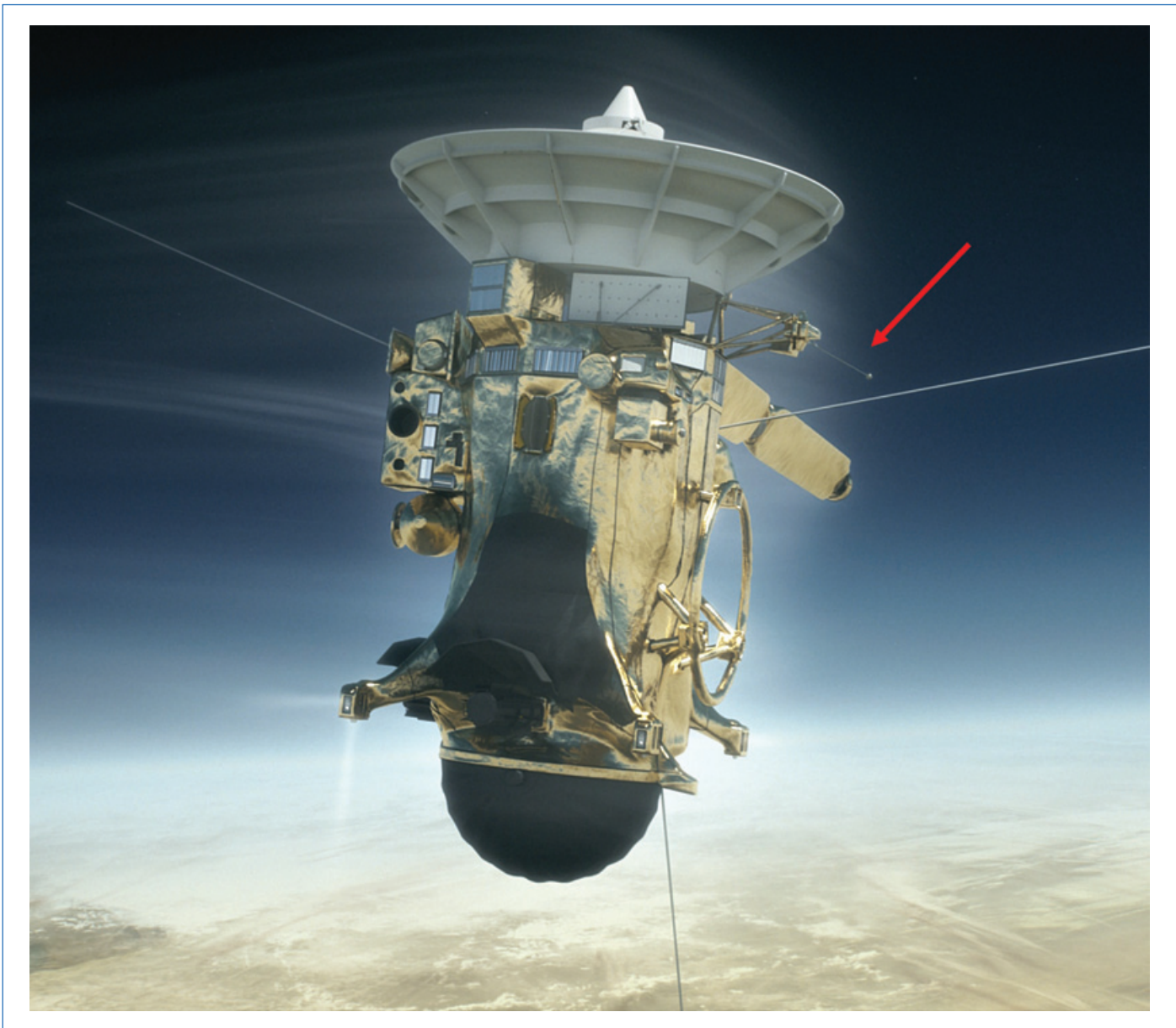
Figure 6 - Position de la sonde de Langmuir, repérée par la flèche rouge, sur la sonde Cassini. © NASA.
